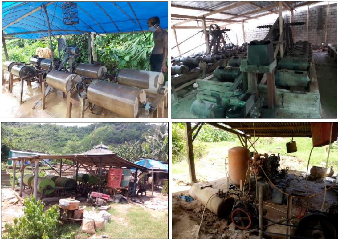
Gambar 3.10. Visualisasi kegiatan pengolahan menggunakan tromol/gelundung di Provinsi NTB
